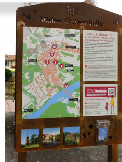
Les panneaux sont conçus en acier Corten, il s'agit d'un acier utilisé pour son aspect et sa résistance aux conditions atmosphériques, dans l'architecture, la construction et l'art principalement en sculpture d'extérieur. C'est un acier qui se rouille sans se corroder et qui dans six mois obtiendra sa couleur définitive.
